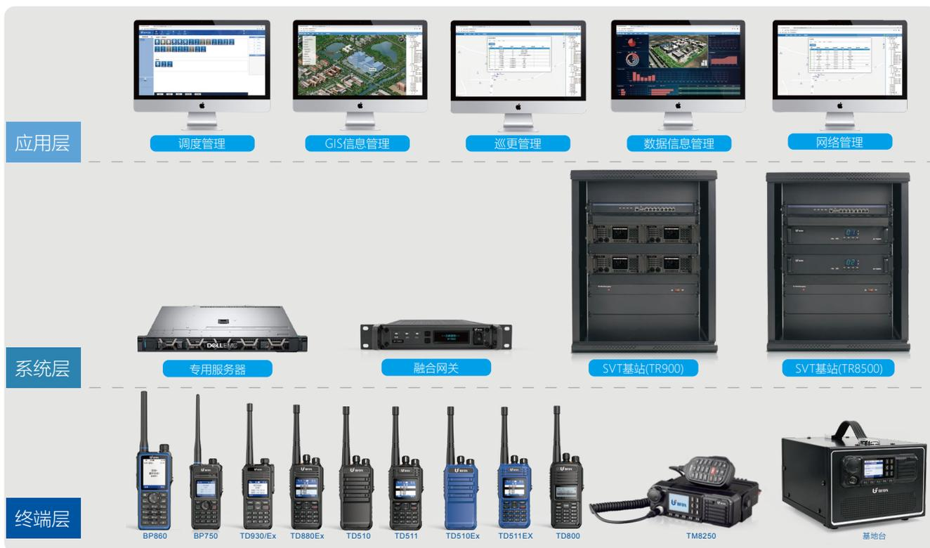
BF-8200智能虚拟集群系统 (Smart Virtual Trunking, 简称“SVT”)是北峰自主研发的集数字语音、窄带数据、文本信息、卫星定位以及统一调度平台的智能化管理系统。该系统单站最大支持16个信道机,共32个业务信道,当归属信道机繁忙时,系统智能动态分配信道资源,灵活分配站内其它空闲信道机进行通信,提升信道利用率,有效解决话务量密集、多业务并发、工作分组繁多等问题,确保通信畅通;通过部署互联网网关接入电话系统、广播系统等,有效解决不同系统无法互联互通的问题。
