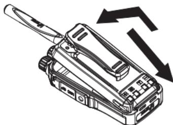
取下电池组时，先把对讲机关闭，然后将对讲机背面顶部的闩锁向下推，使电池组的顶端从对讲机中脱出，然后将电池组取下。
